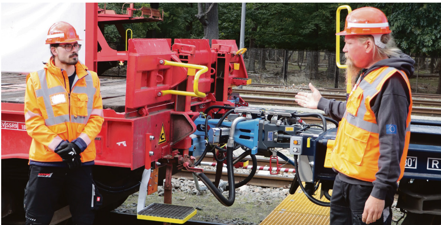
Wagons de marchandises couplés automatiquement et reliés de manière digitale lors de leur présentation à Berlin-Spandau.
